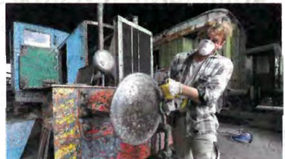
Gafög-Mitarbeiter Heiko Verkamp schleift den alten Lack einer Rangierlok ab.
